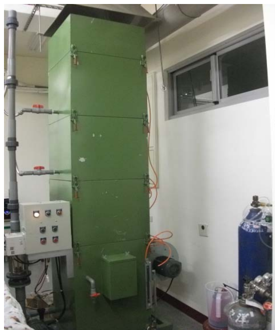
圖 2. 洗滌塔示意圖及實驗塔外觀(正面)
