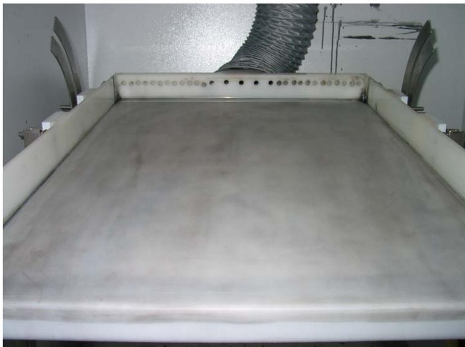
圖 4、密閉腔體流動床式冷風濃縮設備
