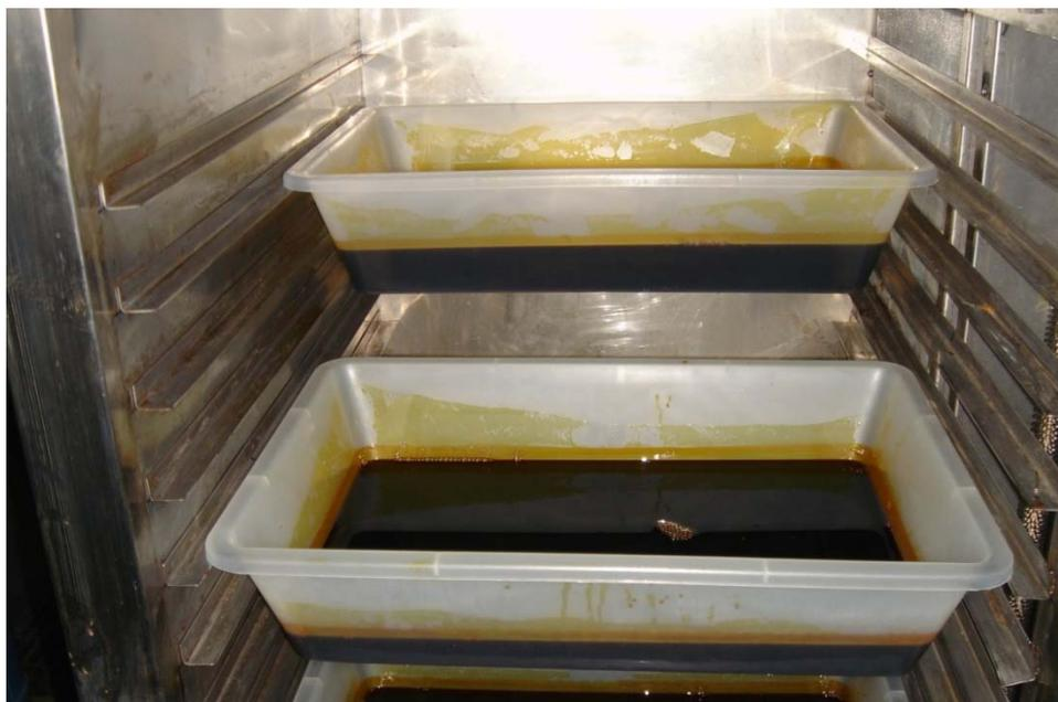
圖 2、固定床式冷風濃縮設備進行濃縮作業之情況
