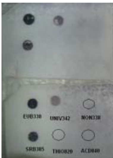
圖 1 好氧反應槽經過二週培養、開始酸化到 pH = 6 後，萃取該反應槽 DNA、標記、雜化所得到的結果。
